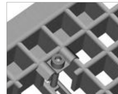
Fixations DFIX Diamond [écrou prisonnier et montage par le dessus]
